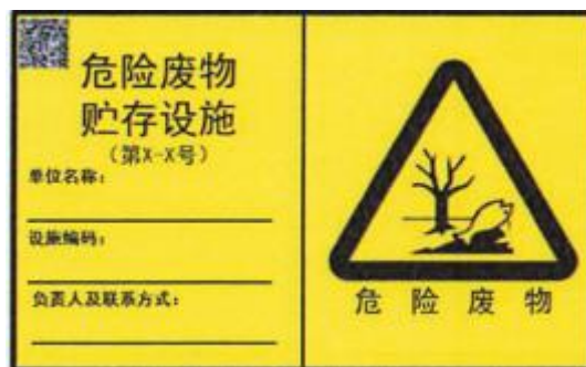
危险废物贮存设施标志
