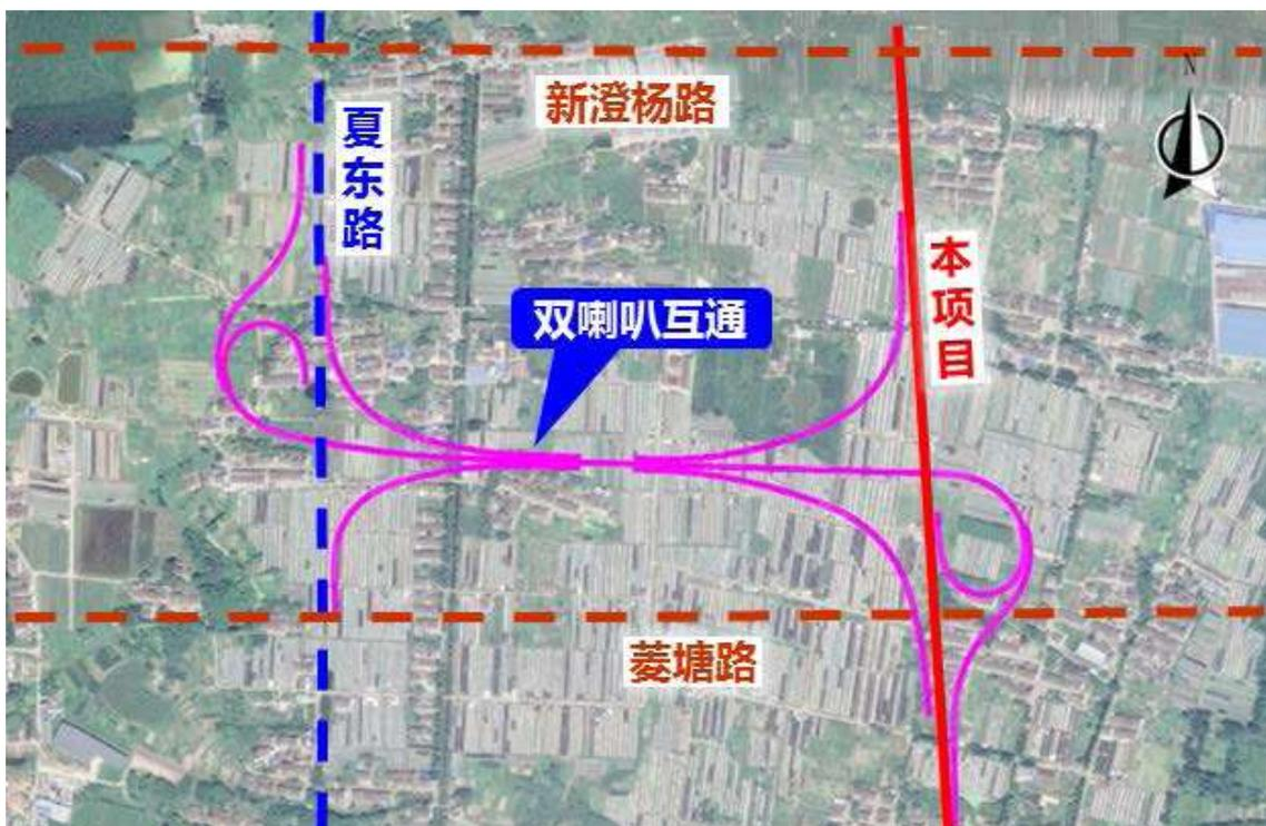
图 2-1-11 夏东路互通平面布置示意图
