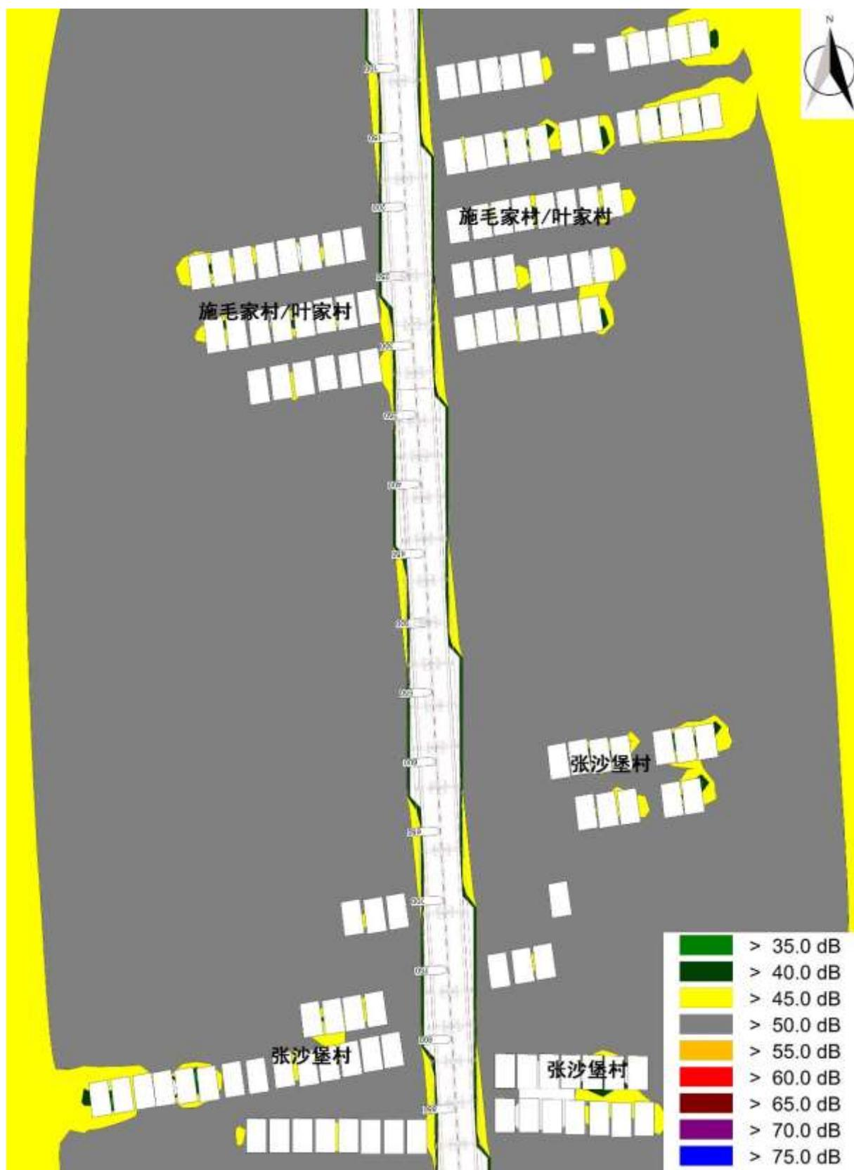
图 4-1-7 K0+000-K0+800 运营中期夜间水平方向等声级线图 H=4.2m
