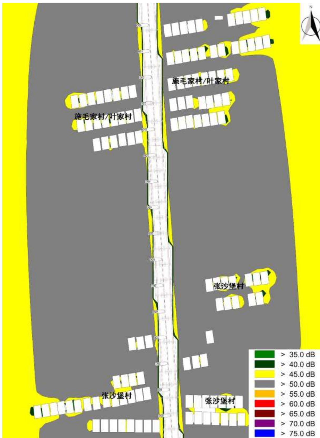
图 4-1-5 K0+000-K0+800 运营近期夜间水平方向等声级线图 H=4.2m
