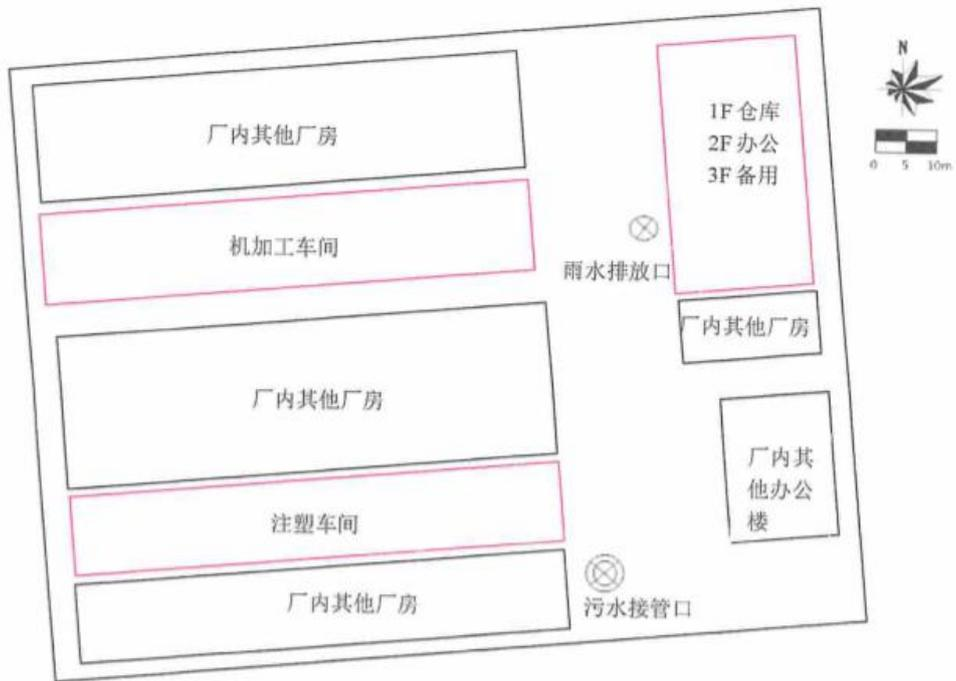
图 3-3 建设项目厂区平面布置图
