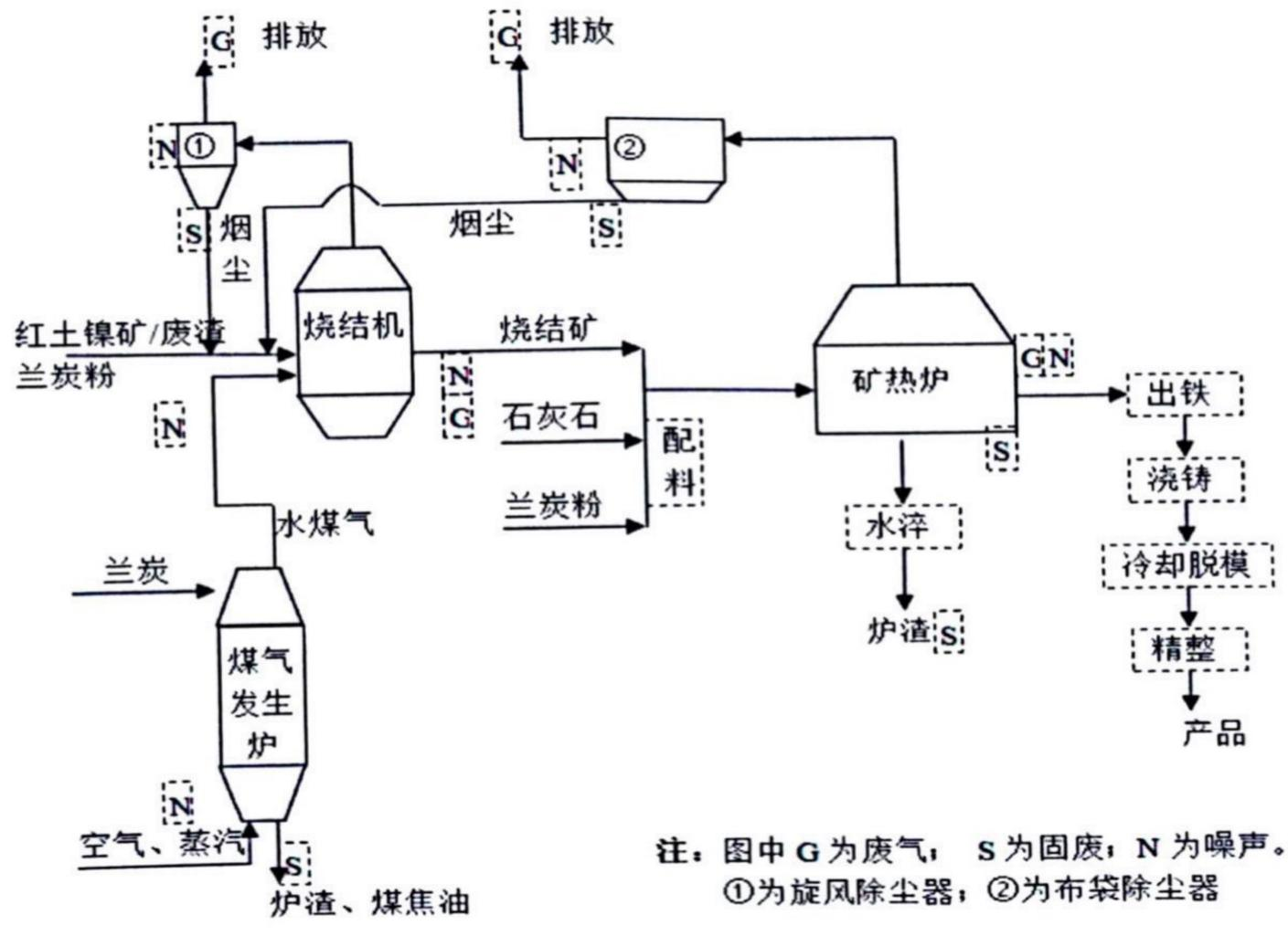
生产工艺流程及产污环节图
